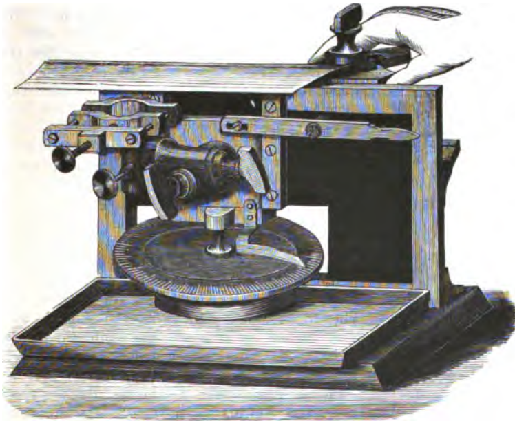
Fig. 110. Mikrotom No. 2 von SCHANZE, Länge der Schlittenbahn 20 cm. Der Preis desselben beträgt mit 1 grossen Klammer, 1 Tischchen für Paraffinpräparate und Gefrierapparat 100 M.
